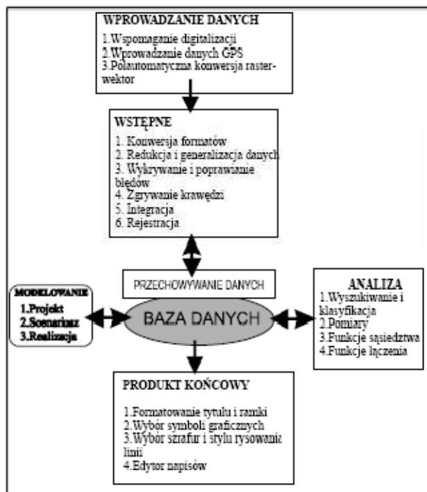
Rysunek 1. Struktura funkcji programu typu GIS
